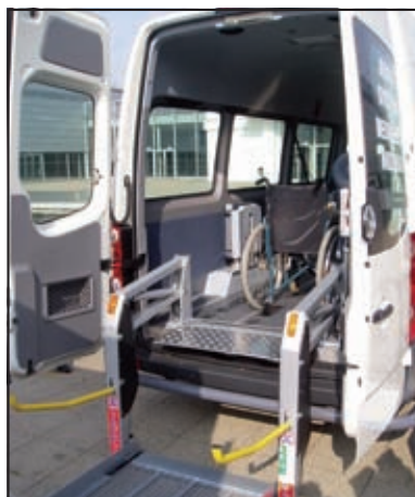
elektrohydraulická plošina slouží pro dopravu vozíčkáře do automobilu
