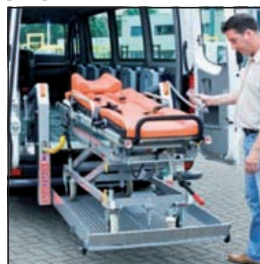
systém umožňuje i převážení ležících pacientů
