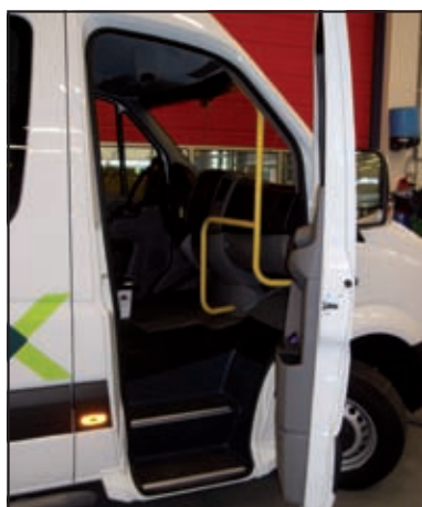
snížený nástupní schod a prodloužení dveří
