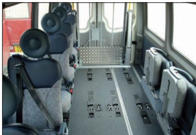
pohled do vozu na složená sedadla a podlahové upínáče invalidních vozíků
