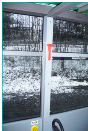
Lehce ovládaná spouštěcí okna s izolačními dvojskly
