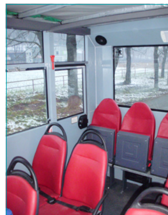
Lehce ovládaná spouštěcí okna s izolačními dvojskly
