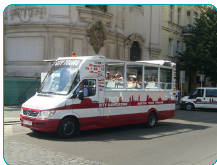
Středně velký vyhlídkový autobus na podvozku MB Sprinter, pro 19 nebo 23 cestujících.
