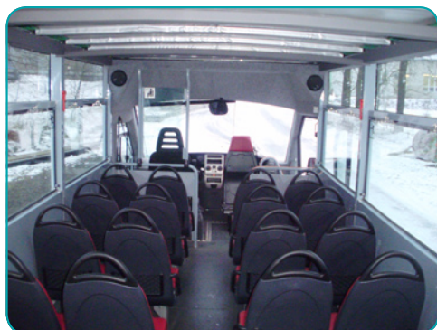
Pohodlná sedadla jsou pro větší bezpečnost vybavena dvou, nebo i třibodovým pásem.
