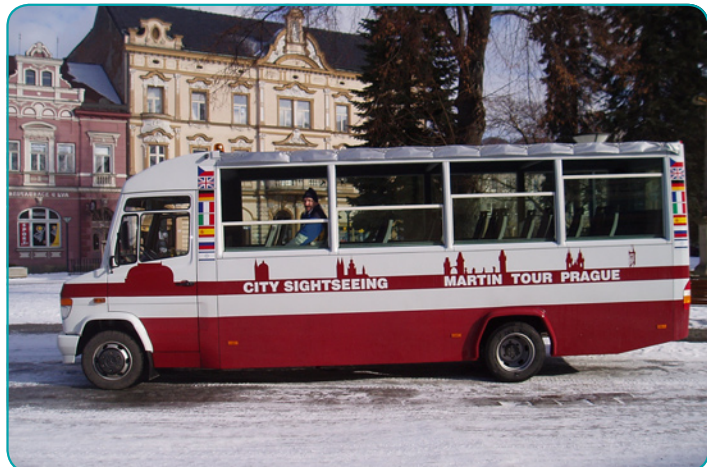
Větší vyhlídkový autobus na podvozku MB Vario, dvě varianty šířky karoserie umožňují v jedné řadě 2+1, nebo 2+2 sedadel.
